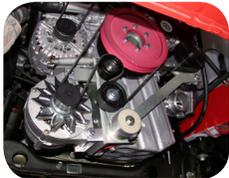
Mercedes 515CDI mit Dynawatt 5kVA Antrieb über Micro-V Riemen
