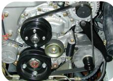
Renault 160XL mit DYNAWATT 4kVA Antrieb über Micro-V Riemen
