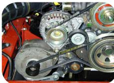
IVECO Turbo Daily mit 4000 Watt DYNAWATT, Antrieb über Micro-V Riemen
